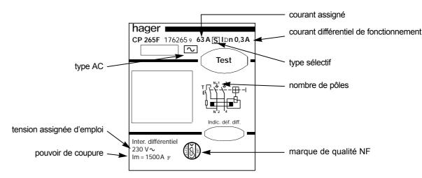
Les caractéristiques d'un interrupteur différentiel doivent être indiquées de la façon suivante :
